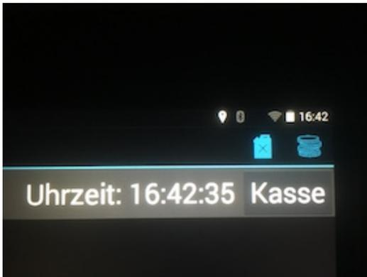
In dem Fahrassistenten ( Anzeige der nächsten drei Haltestellen ) wird am Bildschirmrand oben rechts das Symbol für Wechselgeld angezeigt. Bei Betätigung des Buttons öffnet sich die Kassenlade beim Star mPoP Drucker.
